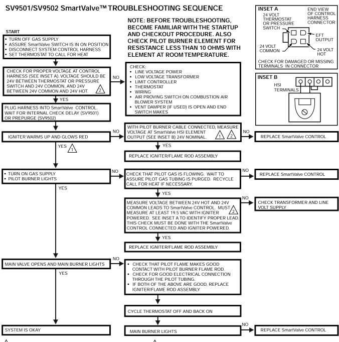
IGNITER WILL CYCLE OFF AND BACK ON ONCE DURING THE 90 SECOND IGNITION TRIAL. ALL VOLTAGE MEASUREMENTS MUST BE TAKEN WHILE THE IGNITER IS POWERED.
