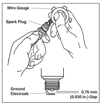
Figure 16. Servicing Spark Plug.
