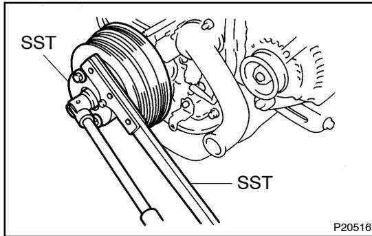
**13. INSTALL CRANKSHAFT PULLEY**
